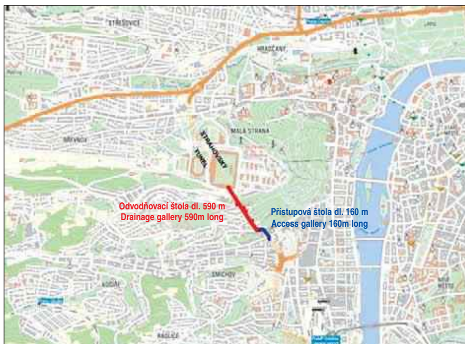
Obr. 1 Přehledná situace Strahovských tunelů a odvodňovací štoly Fig. 1 Synoptic layout of the Strahov tunnels and the drainage gallery
