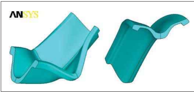
Obr. 3 Modelování deformace průřezu MKP [3] Fig. 3 FEM modelling of a cross-section [3]
