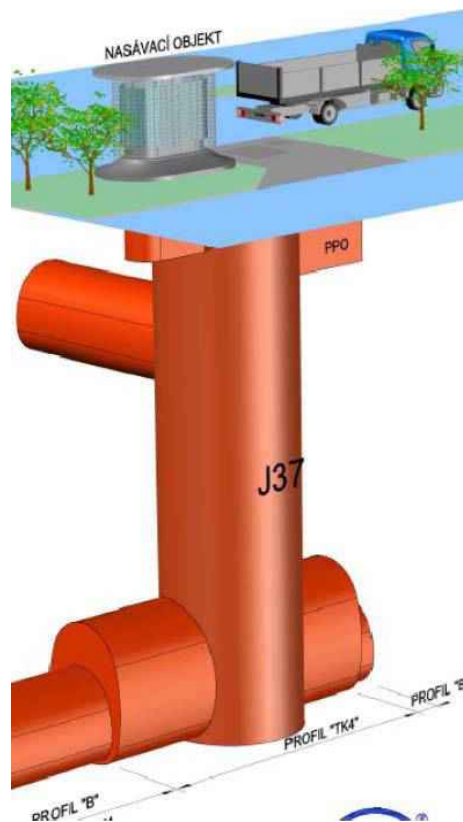
Obr. 7 Technická komora TK 4
